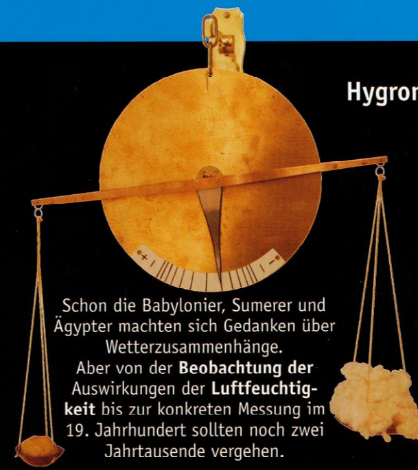
Hygroskopwaage/Hygrometer gebaut nach einer Zeichnung von Leonardo da Vinci
